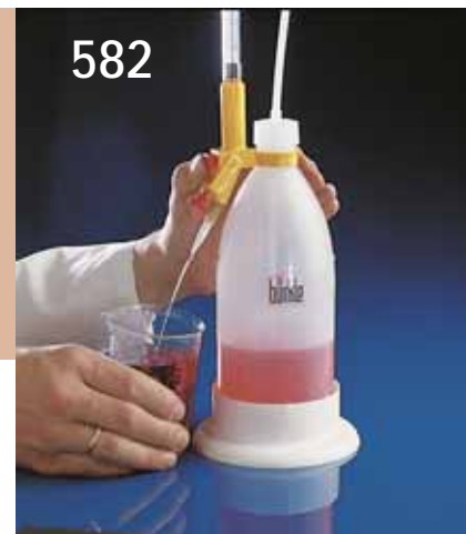
582. Byretter Schilling av boro- silikatglas klass B enl. DIN 12700, flaska av polyeten
